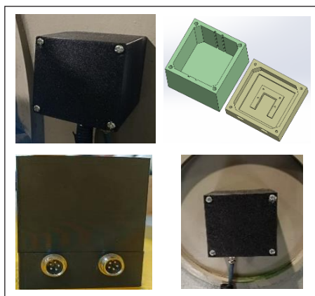
شکل ۱- سنسور ارتعاش ساخته شده با قابلیت شبکه کردن چندین سنسور و ارسال داده ها
