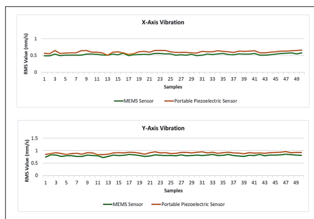
شکل ۲- مقایسه نتایج سنسور ساخته شده بر اساس MEMS با دستگاه ارتعاش‌سنج پرتابل مبتنی بر پیزوالکتریک
