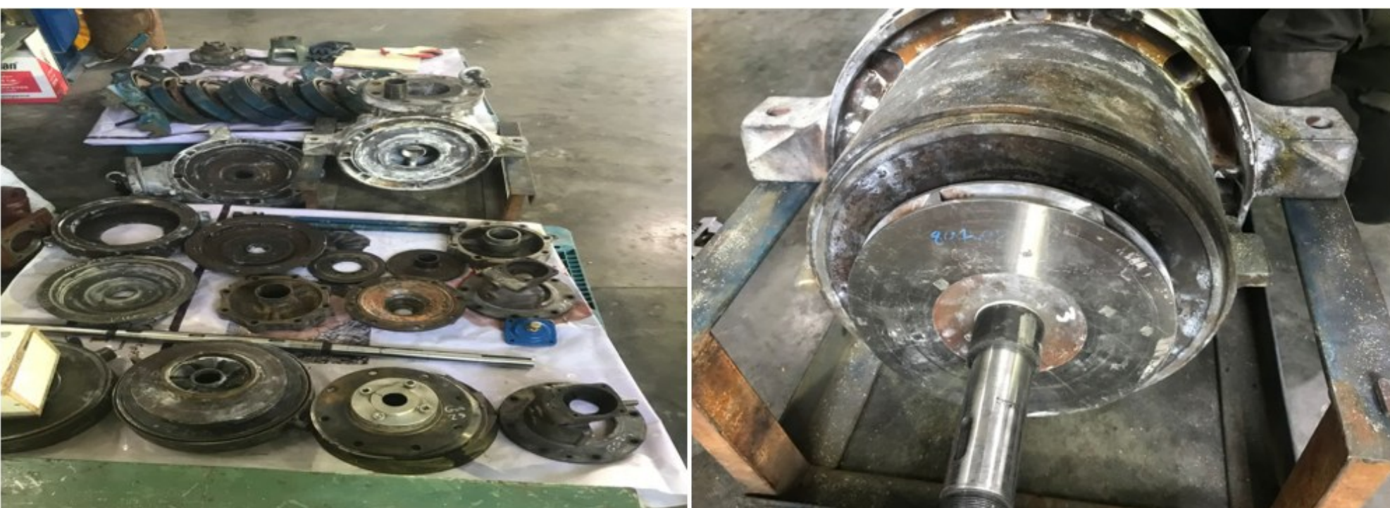
شکل ۵: دمونتاژ پمپ آبداغ فرسوده ژاپنی
