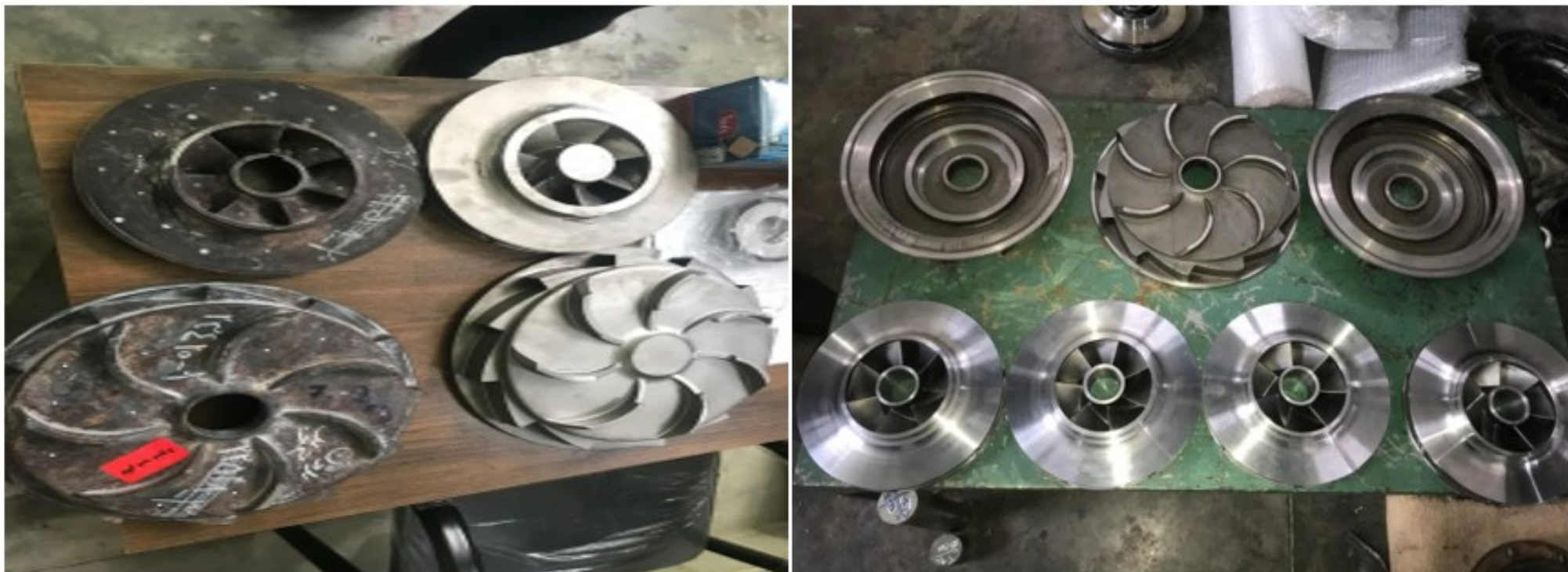
شکل ۴: ریخته‌گری و ساخت قسمت‌های مختلف پمپ
