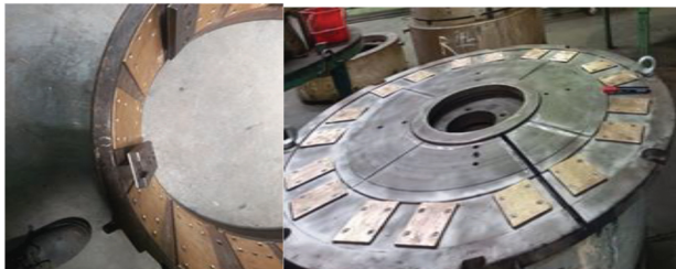
شکل (4) تعویض صفحات سایشی با در نظر گرفتن فرم تنظیمات قالب و بررسی کانتینرها با توجه به سال ساخت
