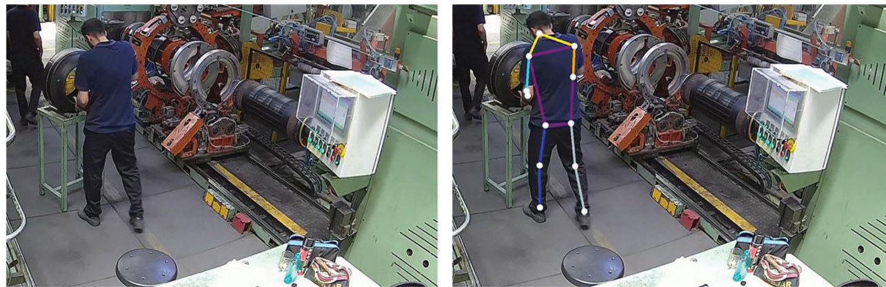
شکل ۲- نمونه‌ی خروجی پردازش ویدئو در ایستگاه تایرسازی تک‌مرحله‌ای 507. (چپ) فریم خام، (راست) خروجی Pose Estimation با نمایش نقاط کلیدی و اتصالات اسکلتی.
