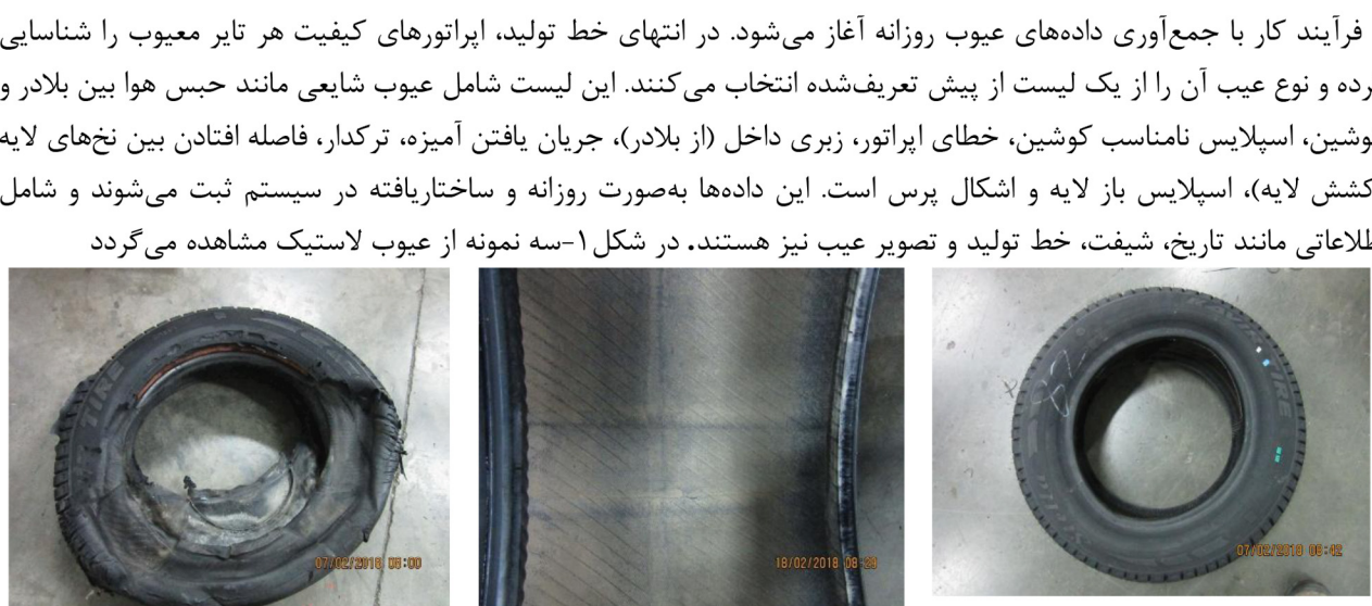
شکل ۱- سه نمونه از عیوب تایر به ترتیب از سمت راست به چپ ۱-خمش بید ۲-تجمع اسپالایس ۳- اشکال پرس
