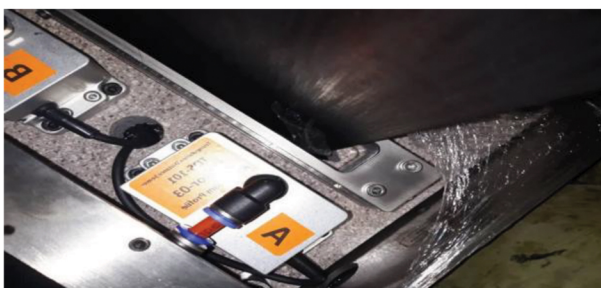
شکل ۱: تصاویری از سنسورهای لیزری و ساختار آنها در سامانه ضخامت‌سنج سه‌نقطه‌ای در حالت توقف ماشین (راست) و حالت در حال تولید (چپ)
