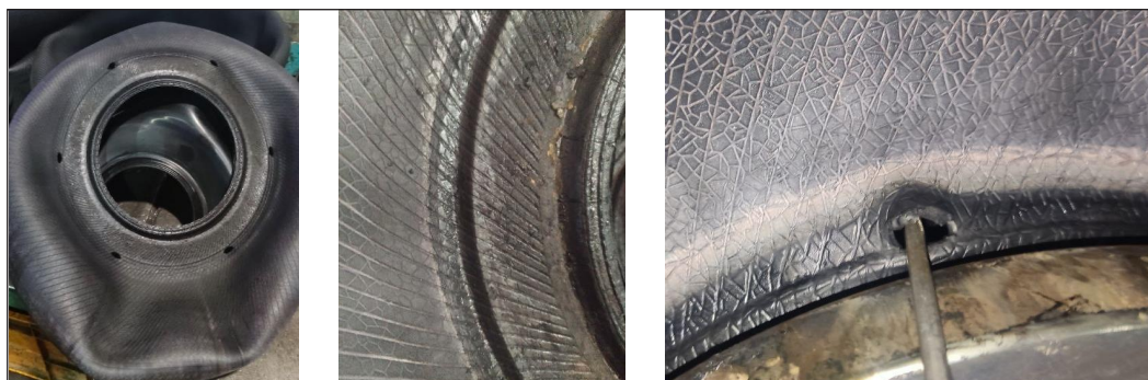
شکل ۲- پله‌ای شدن یا قیچی شدن بلادر بین کلمپ و بیدرینگ
