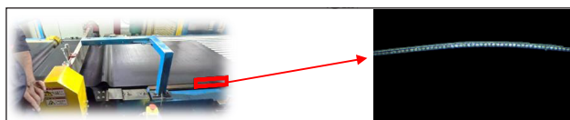
شکل ۵- استفاده از دوربین‌های صنعتی در تشخیص عیب بی‌نخی لایه نخی
